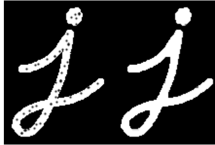
Figura 2.12: Ejemplo de aplicación de la eliminación de ruidos según MorphologyEx de clase "close". Extraído de [32].
