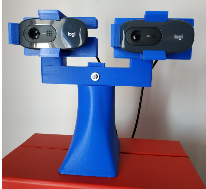
Figura 5.6: Montaje de cámaras en sistema de sujeción.
