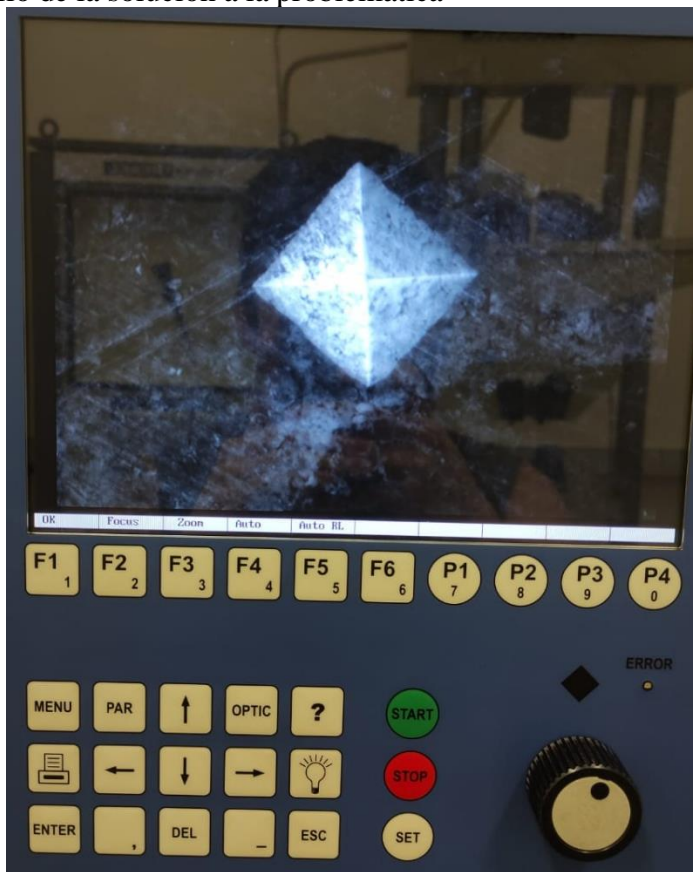
Figura 25: Imagen entregada por la máquina para su medición de las diagonales
