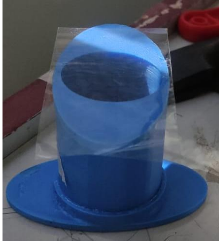
Figura 22: Molde ensamblado con cinta adhesiva para evitar suciedad que pudiera ingresar a la resina
