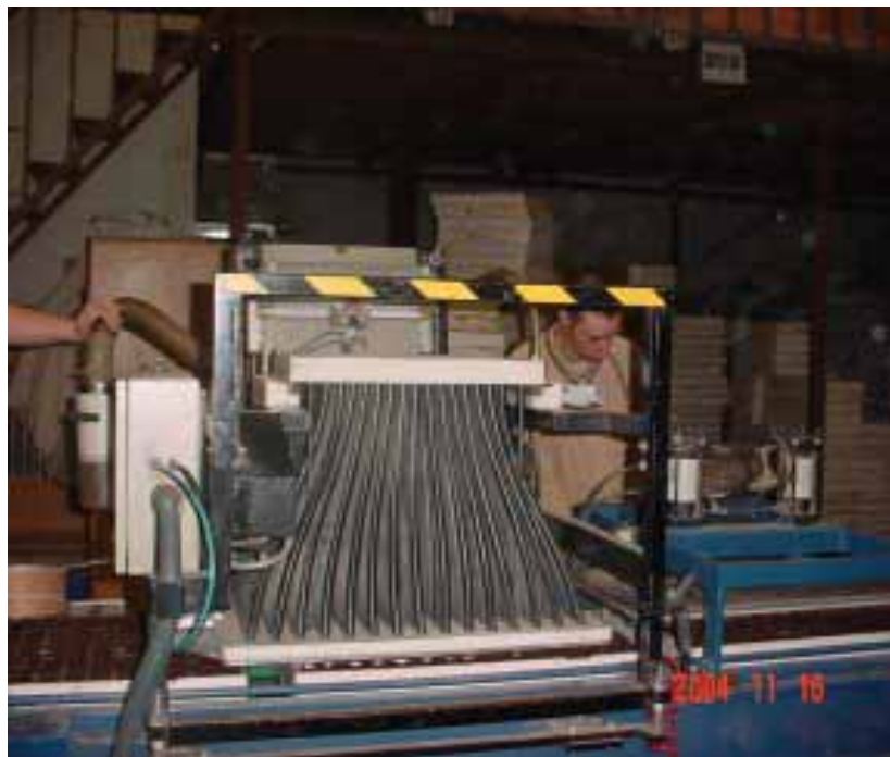
Fotografía 21: Siembra automatizada de bandejas de poliestireno.
