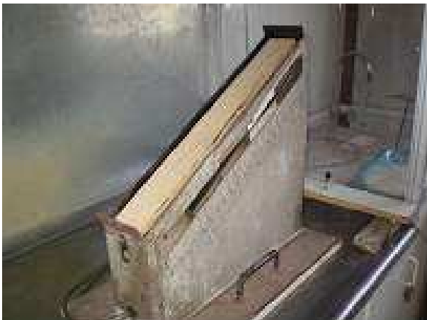
Túnel de Vandersall
