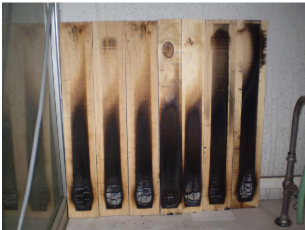
Avance de llama en pino radiata
